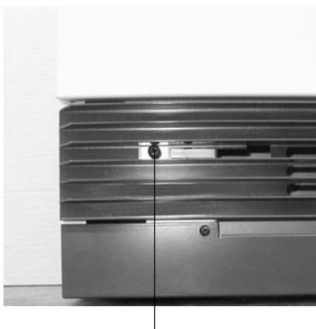
fig.2 Tornillo de fijación de la rejilla de salida de aire
