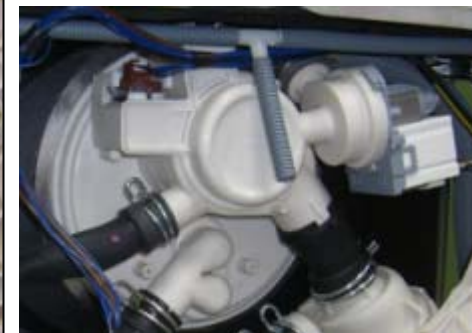
Pompe de recyclage triphasé et son module moteur
