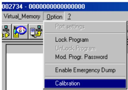
6. Tapez le mot de passe **CAL** (lettres majuscules) et confirmez. Sélectionnez la rubrique RH et confirmer avec OK. Dans la fenêtre successive, sélectionnez le premier point de calibrage à 75%HR et cliquez sur OK. La fenêtre ci-dessous apparaît à l'écran **mais il ne faut pas confirmer immédiatement**:
