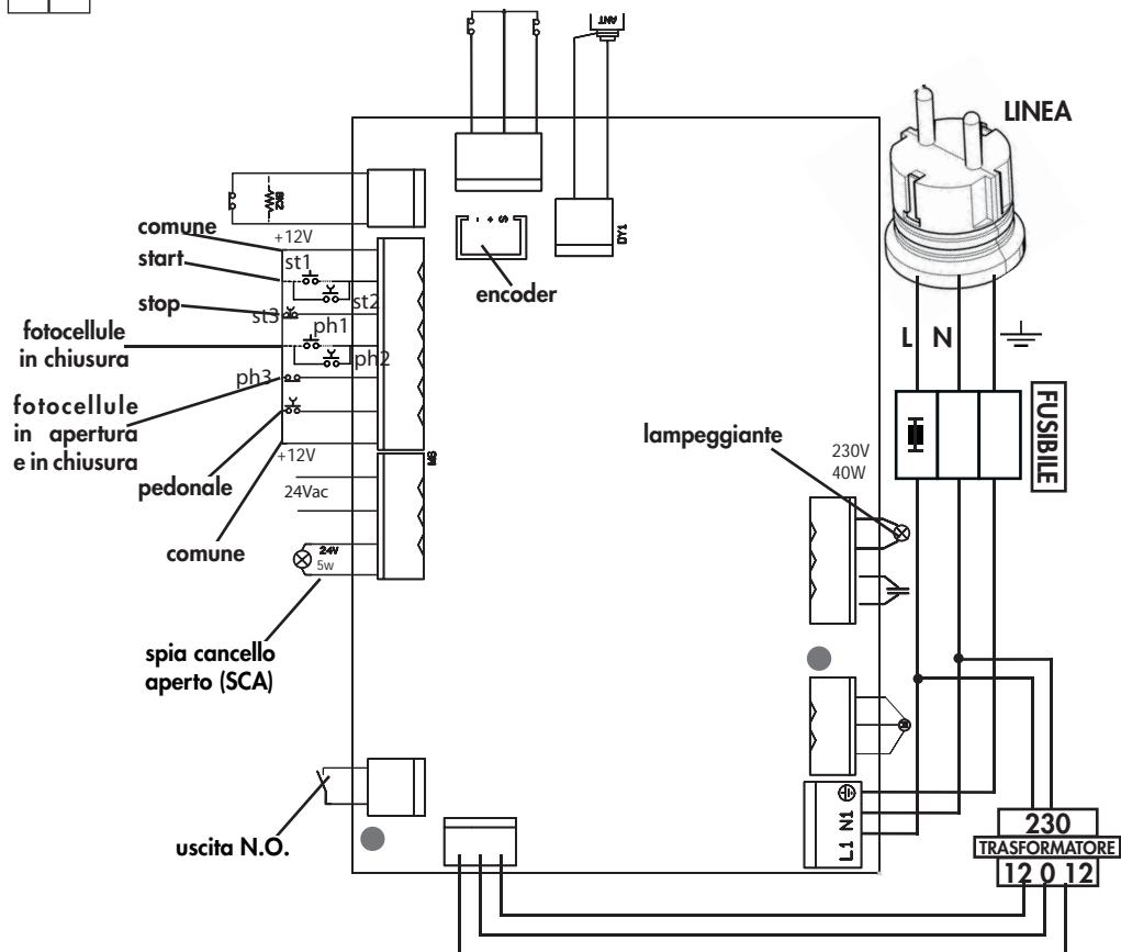
La linea di alimentazione (230V L,N, $\overline{\text{L}}$ ) verso l'automatismo deve essere protetta da un interruttore magnetometrico oppure da una coppia di fusibili da 5A. Un interruttore differenziale è consigliato ma non indispensabile se già presente a monte dell'impianto.
