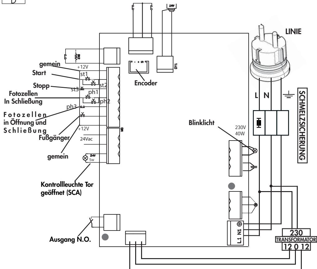
**Die Versorgungsleitung (230V L,N,GND) zur Automatik muss durch einen Magnetschalter oder ein Sicherungspaar von 5A geschützt werden.** Ein Differenzialschalter wird empfohlen, ist jedoch nicht unbedingt notwendig, wenn er schon oberhalb der Anlage vorhanden ist.
