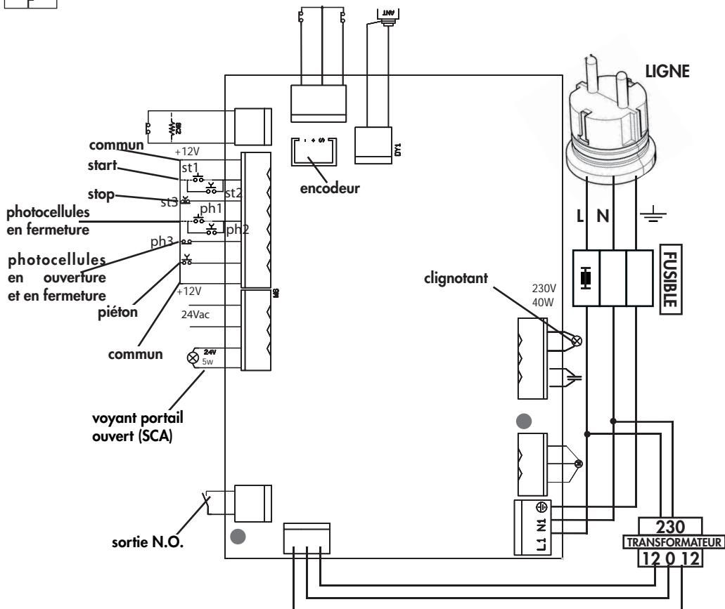
La ligne d'alimentation (230V L,N, $\frac{1}{\text{---}}$ ) vers l'automatisme doit être protégée par un interrupteur magnétométrique ou bien par un couple de fusible de 5A. Un interrupteur différentiel est conseillé, mais non indispensable si déjà présent en amont de l'installation.
