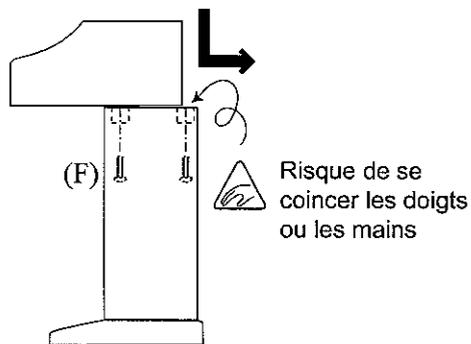
3. Posez le piano légèrement sur l'avant du stand pour que les trous des équerres métalliques soient visibles depuis le dessus, à l'arrière du piano. Glissez le piano vers l'arrière en le maintenant d'une main pour qu'il ne s'incline pas et ne tombe pas du stand. Les crochets du piano s'engagent alors sur les équerres métalliques des Panneaux latéraux. Prenez garde de ne pas vous coincer un doigt ou une main entre le stand et le piano. Immobilisez le piano sur le stand avec quatre Vis (F).
