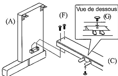
1. Vissez la Butée réglable (pied réglable en hauteur pour l'appui central du pédalier sur le sol) sur le dessous du Pédalier (C)
