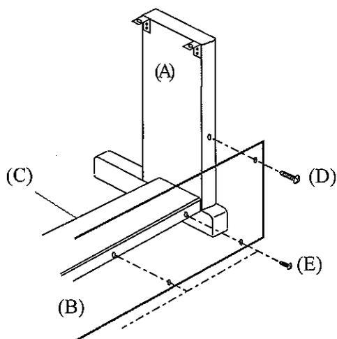
2. Assemblez les Panneaux (A) avec le Panneau arrière (B) à l'aide des deux Vis (D).
