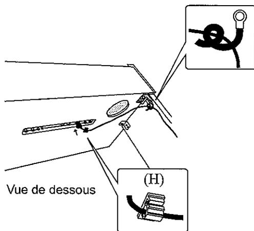
4. Branchez le câble du Pédalier (C) dans la prise PEDAL du piano et fixez-le sur le côté à l'aide des agrafe et serre-câbles adhésifs (H).
