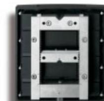
Pour garantir que l'échantillon soit bien fixé, les platines en métal ou en plastique sont montées dans l'embase au moyen d'un étoupe. De plus, c'est le système de serrage approprié pour les blocs rectangulaires jusqu'à 80 x 100 mm.
