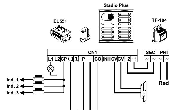
Para abrir la puerta en cualquier momento mediante un pulsador externo, colocar el pulsador entre los bornes ' $\sim 1$ ' y 'CV' (el cercano al borne INH) de la placa. Esta función es especialmente útil para permitir la salida del edificio sin necesidad de llave.
