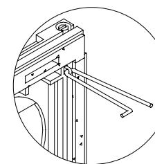
Déterminer le sens d'ouverture de la plaque de rue. Positionner les deux tiges charnières, qui doivent être passées dans les fixations métalliques se trouvant aux extrémités des têtes, comme indiqué sur le dessin. Si les tiges charnières sont placées dans les fixations inférieures, l'ouverture du portier s'effectuera vers le bas; si elles sont placées dans les fixations droites, le portier s'ouvrira de gauche à droite.
