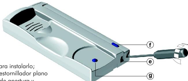
Abrir el teléfono para instalarlo; introducir un destornillador plano en las ranuras de apertura y realizar palanca tal y como muestra el dibujo.
