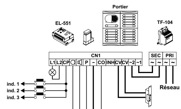
Pour ouvrir la porte à n'importe quel moment au moyen d'un poussoir extérieur, installer le poussoir entre les bornes ' ~1 ~ ' et ' CV ' du groupe phonique comme montré sur le dessin.
