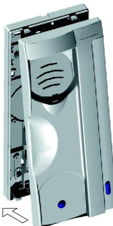
Cerrar el teléfono tal y como muestra el dibujo. Una vez cerrado, conectar el auricular mediante el cordón telefónico y colocarlo en la posición de colgado.
