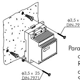
Instale el transformador en un lugar seco y protegido. Recuerde que la normativa vigente obliga a proteger el transformador con un interruptor magnetotérmico.
