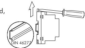
El transformador puede instalarse en guía DIN (3 elementos), realizando una leve presión. Para sacar el transformador de la guía utilizar un destornillador plano y hacer palanca, tal y como muestra el dibujo.
