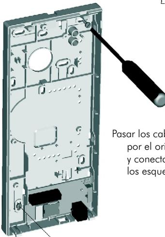
Pasar los cables de la instalación por el orificio dispuesto a tal efecto, y conectarlos a la regleta según los esquemas de instalación.
