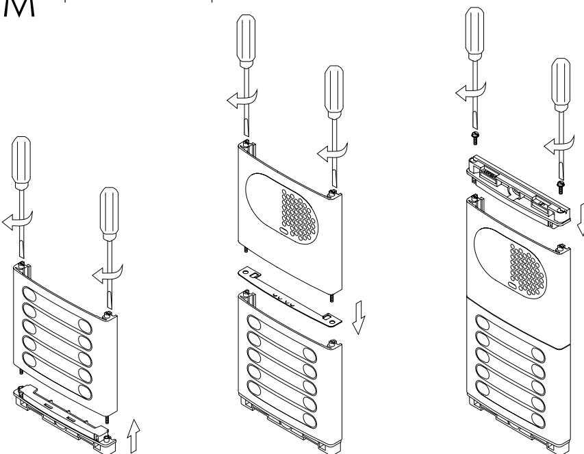
Insertar el cabezal inferior (marcado ABAJO) en el módulo inferior y fijarlo atornillando los ejes del módulo.
