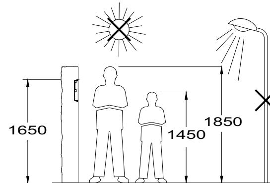
Percer un trou dans le support où l'on souhaite installer la plaque de rue, à une hauteur de 1,65m. Les dimensions du trou dépendent du nombre de modules à placer.
