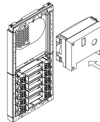
Insérer le micro-hp dans le module grille. Pour un assemblage parfait, aligner le poussoir d'éclairage du porte-nom et le microphone du micro-hp avec les perçages du panneau frontal prévus à cet effet.
