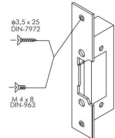
Si el abrepuertas va a ser instalado en una puerta metálica, utilice una broca de 3,5mm y rosque el agujero realizado. Si la instalación se realiza sobre puerta de madera, utilice una broca de 3mm.
