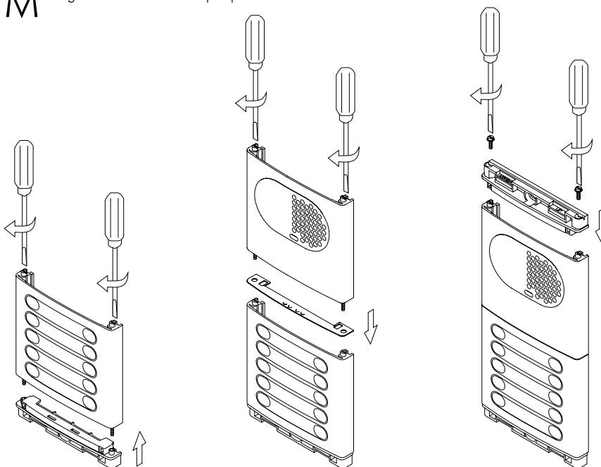
Insérer la traverse de fixation inférieure (marquée ABAJO) dans le module inférieur du portier et visser les deux axes filetés.
