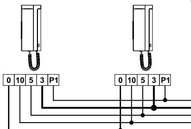
El número máximo de teléfonos en paralelo dentro de una misma vivienda es de tres. Por cada teléfono en paralelo doblar la sección del hilo de llamada a dicho teléfono.
