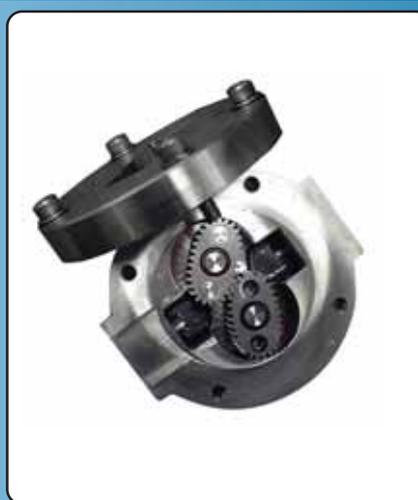
Le débitmètre volumétrique DPDFM, est utilisable pour toute sorte de liquides, des plus basses viscosités jusqu'aux plus élevées. La construction à engrenages elliptiques permet de mesurer le débit et les volumes distribués. Le corps du DPDFM peut être en acier inox ou aluminium, alors que les engrenages elliptiques sont en PPS ou en acier inox. Le DPDFM est équipé du système de blocage "lock and turn" permettant le contrôle d'un ou plusieurs points de relevé.
