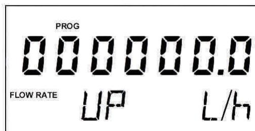
Dans un CH420P, si pendant la programmation on reçoit un commando HART™ qui requiert une réponse, la programmation locale ne sera pas validée et toutes les données précédemment programmées seront perdues. L'écran reviendra au mode de fonctionnement normal avec l'indication PROG éclairée, pour indiquer l'évènement. Pour éteindre l'indication PROG de l'écran, il suffira de presser la touche "Flecha arriba" ou "Flecha izquierda".
