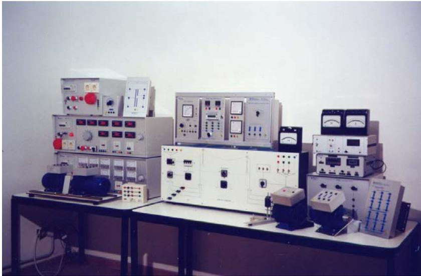
Cette unité didactique simule un vrai système de génération, transmission et utilisation composé de machines électriques et instruments standard, et d'un simulateur de ligne de transmission
