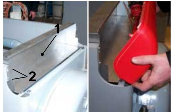
H fixer la boîte de protection du câblage «1» à l'aide des vis «2» sur les côtés et placer le tableau de bord câblé.
