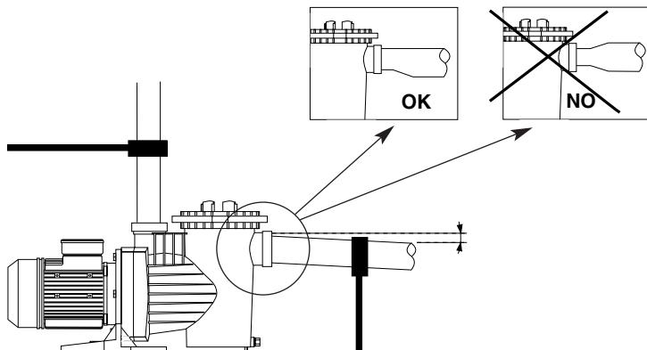
Es muy importante que las tuberías de aspiración e impulsión posean soportes independientes y queden bien fijadas para que de esta manera la bomba no soporte su peso ni las vibraciones producidas por el paso del caudal de agua a través de ellas. En caso de instalar una tubería de impulsión de gran longitud aconsejamos la instalación de una válvula de retención para evitar que el golpe de ariete producido por el retorno del agua al parar la bomba provoque algún desperfecto.
