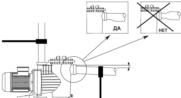
Как всасывающую, так и напорную трубу необходимо тщательно закрепить на отдельных опорах во избежание воздействия нагрузок или вибраций, производимых проходом водяного потока через трубы. В случае установки напорной трубы большой длины рекомендуется установить запорный клапан, который снизит риск гидравлического удара, вызванного обратным током воды в результате остановки насоса.
