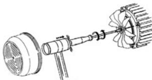
Compruebe que el sentido de giro del motor coincida con el indicado en la placa de características (el ventilador debe girar, mirando por la parte trasera del motor, en SENTIDO HORARIO). Si la bomba es trifásica y observamos que el sentido de giro es incorrecto se deben invertir dos fases de alimentación del cuadro de protección.
