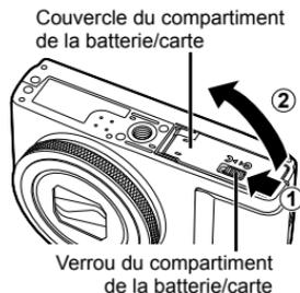
**2** Insérez la batterie tout en faisant glisser la touche de verrouillage de la batterie dans le sens de la flèche.
