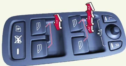
**L R** Réglage du rétroviseur extérieur, sélectionner L ou R. Régler avec le levier.
