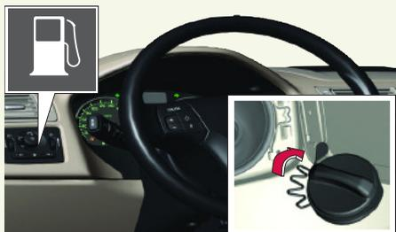
Appuyer sur le bouton pour ouvrir la trappe à essence. Suspendre le bouchon durant le plein.
