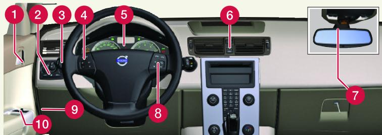
**1** Verrouillage centralisé, poignée d'ouverture de porte
