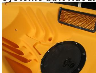
Des trous de drainage dans le cockpit et sur les aires de stockage sont aménagés et permettent d'évacuer l'eau automatiquement au fur-et-à-mesure qu'elle entre.
