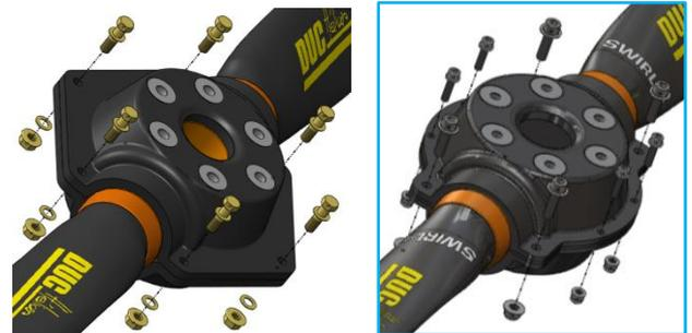
Depuis l'avant du moyeu, mettre en place les 6 vis et rondelle d'assemblage. A l'arrière, placer les rondelles et écrous autobloquants.
