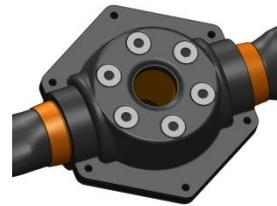
Placer le **demi-moyeu avant** (inserts métallique à petit perçage) sur l'ensemble pour s'emboîter avec les pieds de pale.
