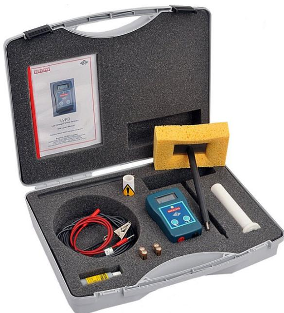
Le détecteur de porosité basse tension Buckleys LVPD utilise la technique de l'éponge humide et permet de tester rapidement et de manière économique et non-destructive des revêtements diélectriques jusqu'à 500 µm sur des substrats conducteurs.
