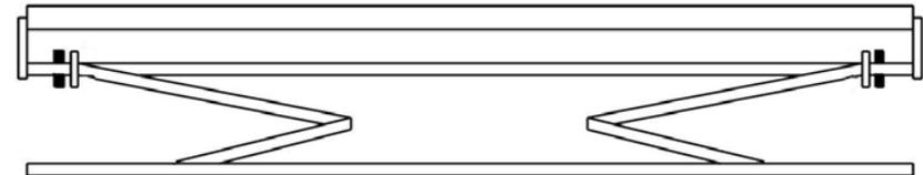
**3 supports de pose // 2 bras:** (Largeur du support de pose: 40mm)
