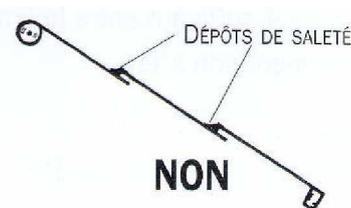
La toile doit impérativement être fixer sur le tube d'enroulement et sur la barre de charge.
