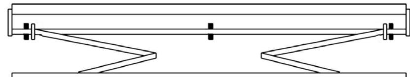
**4 supports de pose // 2 bras:** (Largeur du support de pose: 40mm)
