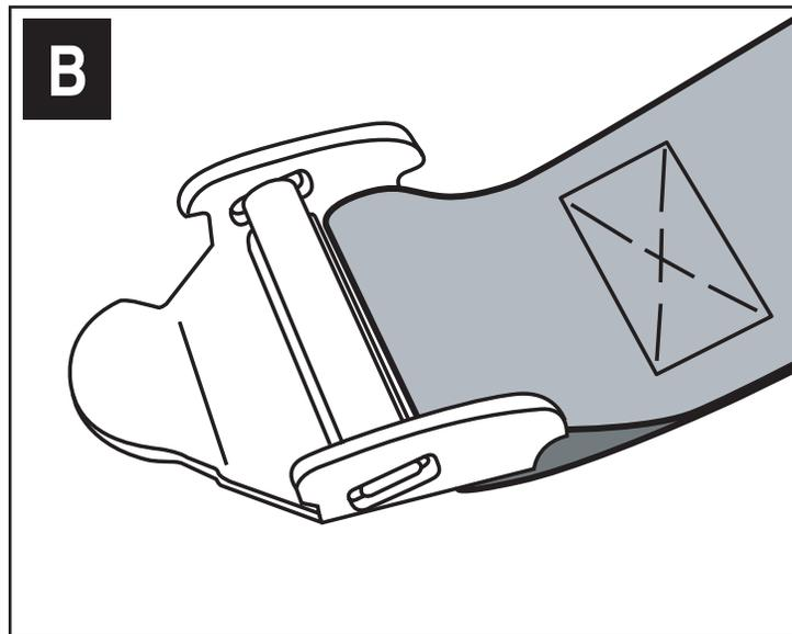
1. Retirer le couvercle en plastique du loquet (Fig. A) à l'aide d'un tournevis standard. Tirer l'extrémité libre de la courroie hors du réglage (Fig. B).
