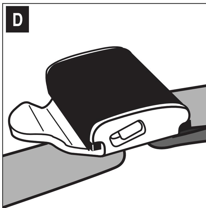
1. Enfiler l'extrémité libre de la courroie vers le haut entre la barre de blocage et l'extrémité attachée de la courroie, puis autour de la barre de blocage et descendre entre la barre de blocage et l'extrémité ouverte du loquet tel que montré à la Fig. C. Assurez-vous que la courroie n'est pas tordue. Remettre en place le couvercle en plastique (Fig. D). La réparation est terminée. Voir le manuel d'instructions pour ajuster la courroie d'ancrage.
