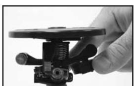
**NOTA:** quando substituir os bicos, tome nota da posição da mola do braço e, caso seja necessário, mude-a. O Pro Impact é fornecido com a mola do braço na posição A. Apenas os bicos n.º 6, 7 e 7 de ângulo baixo necessitam que a mola seja mudada para a posição B. Na posição B, há menos tensão na mola, o que permite um melhor accionamento do impacto com estes bicos de baixo fluxo.
