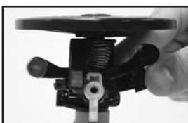
4. Insérez la nouvelle buse dans l'orifice de buse, avec l'attache de la buse dirigée vers le bas. Assurez-vous que la buse est correctement insérée et tournez-la dans le sens horaire, jusqu'à ce que l'attache de la buse s'enclenche dans sa position de blocage.
