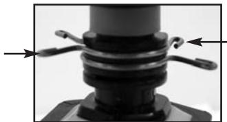
3. A questo punto, aprire le due flangie di regolazione azionamento, premendo una delle linguette fino a raggiungere il grado di giro parziale desiderato. Assicurarsi che il meccanismo d'azionamento inverso, montato sulla linguetta di regolazione, NON sia in posizione orizzontale (verso l'alto), ma in posizione verticale (verso il basso) tra le due flangie di regolazione dell'azionamento, in modo da invertire correttamente la modalità di giro parziale.
