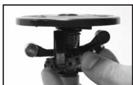
3. Con los dedos índice y pulgar empuje el saliente de la boquilla (que está a la izquierda de la boquilla) hacia delante mientras la gira en dirección contraria a las agujas del reloj hasta que la boquilla se desliza fuera de la posición de bloqueo.
