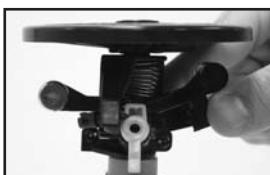
4. Coloque la boquilla nueva en el agujero para boquillas con el saliente de la boquilla mirando hacia abajo. Asegúrese de que la boquilla queda bien asentada y gírela en la dirección de las agujas del reloj hasta que el saliente de la boquilla encaje en la posición de bloqueo.
