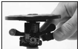
2. Mueva el brazo doble compensado para alejarlo de su posición de reposo y sujetelo de modo que la boquilla quede claramente visible.
