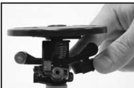
**NOTA:** In caso di sostituzione dell'ugello, notare la posizione della molla del braccio e all'occorrenza sostituirla. Il Pro Impact viene spedito con la molla del braccio in posizione A. Solo gli ugelli n. 6, n. 7 e n. 7 ad angolo ribassato richiedono la sostituzione della molla in posizione B. In posizione B infatti, la tensione della molla è inferiore, il che consente un miglior azionamento dell'Impact sugli ugelli a flusso ridotto.
