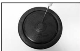
2. Debajo de la tapa hay cuatro agujeros. Alinee uno de los agujeros con uno de los dos rebordes que aguantan la tapa. Seguidamente deslice el destornillador por el agujero y por encima del reborde. Ahora haga palanca con el destornillador poniendo presión sobre el reborde y tire de la tapa con la otra mano. La tapa saldrá fácilmente para poder acceder a la unidad de impacto.
