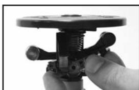
3. À l'aide votre doigt et de votre pouce, tirez l'attache de la buse (située à gauche de la buse) vers l'avant tout en la tournant dans le sens antihoraire, jusqu'à ce que la buse glisse en dehors de sa position de blocage.
