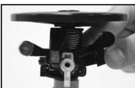
4. Posizionare il nuovo ugello nel foro apposito con la linguetta rivolta verso il basso. Assicurarsi che l'ugello sia correttamente posizionato e ruotarlo in senso orario fino a quando la linguetta non sarà bloccata.
