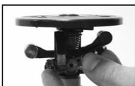
3. Utilizando o dedo indicador e o polegar, puxe a parte saliente do bico (do lado esquerdo) para a frente, rodando-a simultaneamente para a esquerda, até o bico deslizar para fora da sua posição de bloqueio.
