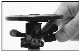
**NOTA:** Cuando cambie la boquilla, fíjese en la posición del muelle del brazo y cámbiela si es necesario. El aspersor Pro Impact viene preinstalado con el muelle del brazo en la posición A. Sólo hay que cambiar el muelle a la posición B para las boquillas números 6, 7 y 7 de ángulo bajo. En la posición B hay menos tensión en el muelle lo que permite un mejor accionamiento del impacto con estas boquillas de poco caudal.
