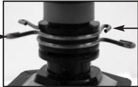
3. Em seguida, mova os 2 anéis de ajuste do accionamento empurrando um dos elementos salientes para a posição do grau de Círculo Parcial pretendido. Certifique-se de que o mecanismo de accionamento de inversão montado sobre os anéis de ajuste NÃO está na posição horizontal (virado para cima). Este deve estar na posição vertical (virado para baixo) entre os 2 anéis de ajuste do accionamento, de forma a inverter adequadamente o movimento do aspersor no modo de Círculo Parcial.
