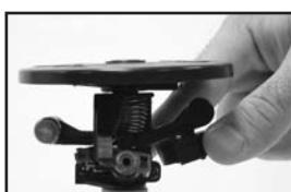
**REMARQUE :** lors du changement de buse, assurez-vous de noter la situation du ressort du bras et changez-le si nécessaire. Le Pro Impact est livré avec le ressort du bras en position A. Seules les buses à angle faible #6, #7 et #7 nécessitent de déplacer le ressort en position B. En position B, il existe moins de tension dans le ressort, ce qui permet un meilleur parcours du percuteur sur ces buses à faible flux.
