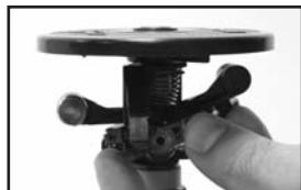
3. Con pollice e indice, tirare in avanti la linguetta dell'ugello (che è sulla sinistra dell'ugello), ruotandola in senso antiorario fino a quando l'ugello non si sbloccherà.
