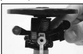
4. Coloque o novo bico no orifício para bicos com a parte saliente do mesmo a apontar para baixo. Certifique-se de que o bico está bem inserido e rode-o para a direita até a parte saliente do bico encaixar na posição de bloqueio.
