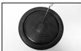
2. Sous le capuchon se trouvent quatre trous. Alignez l'un des trous avec l'une des deux brides qui tiennent le couvercle en place. Puis faites glisser le tournevis à travers le trou et en haut de la bride. Maintenant, soulevez le tournevis en appuyant sur la bride et tirez le couvercle vers le haut de l'autre main. Le couvercle sautera tout seul, pour un accès facile au percuteur.
