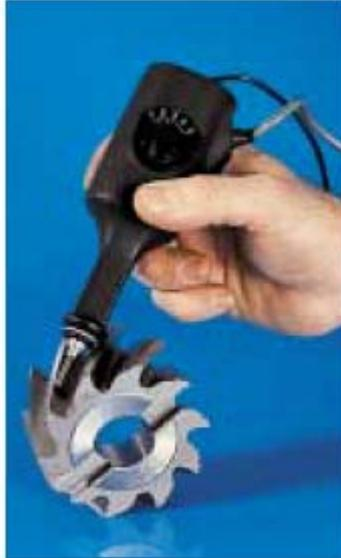
Le **CARBIDIZER** est conçu pour déposer une couche de carbure de tungstène ou de carbure de titane, sur les faces d'usures d'outils en acier rapide, de matrices, de poinçon ... sans avoir à les chauffer.
