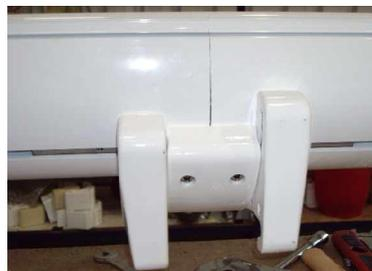
Les piges (99990050) et les réglettes doivent être soigneusement mises en place et doivent être bien fixées.
