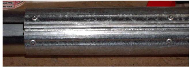
Insérer la moitié du raccord de tube enrouleur dans un des deux tubes à raccorder.
