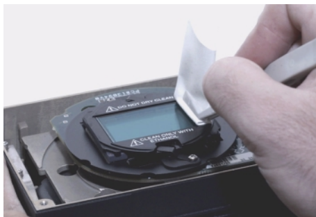
Figure 3. Nettoyage du verre du filtre à infrarouge
