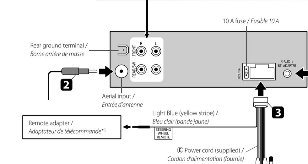
Connecting the Bluetooth adapter or portable audio player / Connexion de l'adaptateur Bluetooth ou d'un lecteur audio portable
