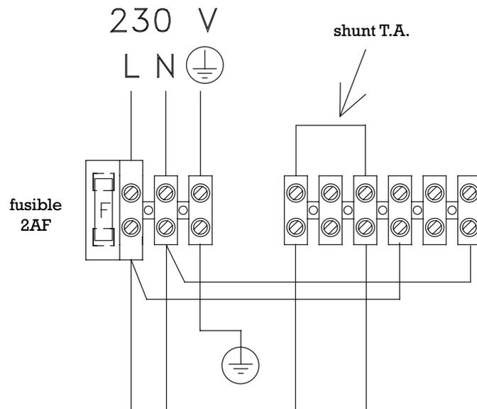
Brancher le thermostat d'ambiance de la façon indiquée sur le schéma après avoir ôté le cavalier du bornier à 6 pôles. Les contacts du thermostat d'ambiance doivent être dimensionnés pour  $V = 230$  Volt
