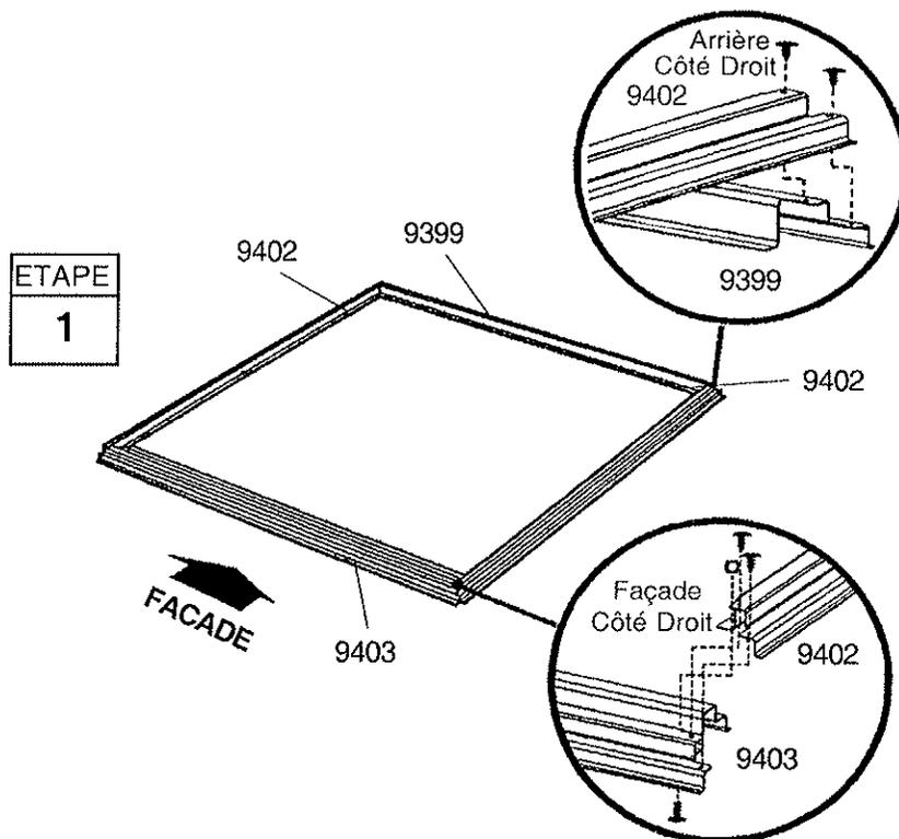
**2** Mesurez les diagonales du cadre de plancher. Lorsqu'elles sont égales, le cadre de plancher est d'équerre.
