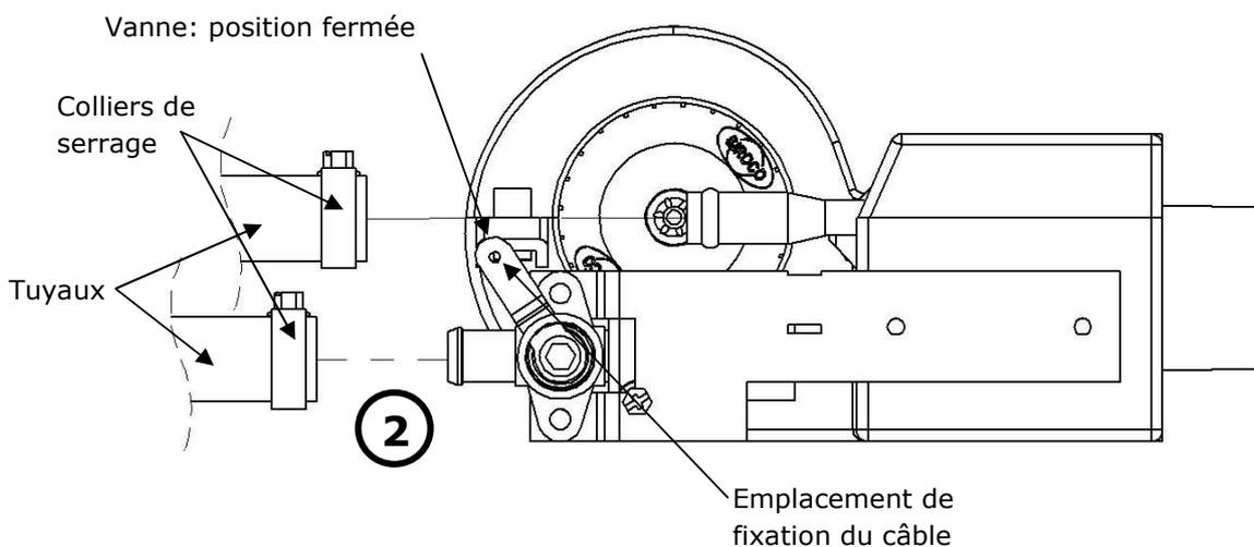
Raccorder la vanne à câble de la même façon, en utilisant un collier de serrage adapté. Fixer le câble sur le levier de la vanne: la course minimale du câble doit être 47 mm pour assurer la rotation du levier.
