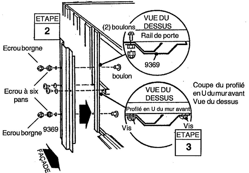
**2** Fixer un jambage de porte sur le panneau avant à l'aide de deux boulons, écrous et écrous borgnes, comme illustré.
