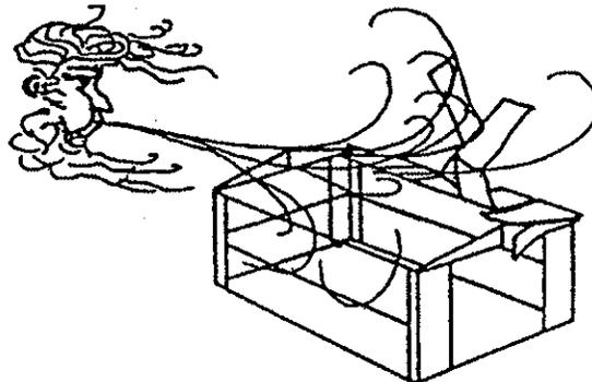
• Ne tentez pas de monter l'abri par un jour de vent parce que les grands panneaux faisant fonction de "voile" peuvent être fouettés par le vent, rendant ainsi la construction difficile et dangereuse.
