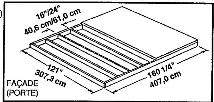
Note : La plate-forme ou la dalle dépassera de 1,4 cm (9/16") le cadre de plancher sur les quatre côtés. Pour une plate-forme en bois, scellez ce surplomb de 1,4 cm (9/16") avec du ciment pour toiture (non fourni). Pour une dalle en béton, biseautez ce surplomb de 1,4 cm (9/16") quand vous coulez le béton. Vous assurerez ainsi un bon écoulement des eaux.
