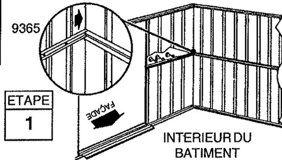
**1** Fixer les profilés en U du mur avant à leurs positions entre l'extrémité du profilé en U du mur latéral et le panneau d'angle à l'aide de vis. A ce stade, ne pas insérer de vis dans le trou pratiqué à l'extrémité derrière l'ouverture de porte.
