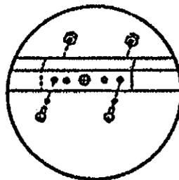
Utilisez des boulons et des écrous à travers le recouvrement des cornières à la partie supérieure du panneau arrière
