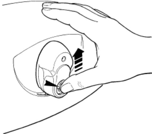
2 Tourner la poignée de débrayage et manœuvrer le vantail à la main
