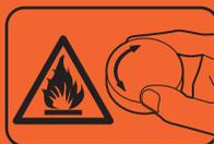
Laissez le moteur se refroidir avant d'ouvrir le réservoir d'essence. Les vapeurs d'essence sont très inflammables et peuvent s'enflammer au simple contact avec les surfaces chaudes de l'appareil.
