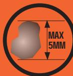
La pompe peut absorber des particules jusqu'à 5 mm.
