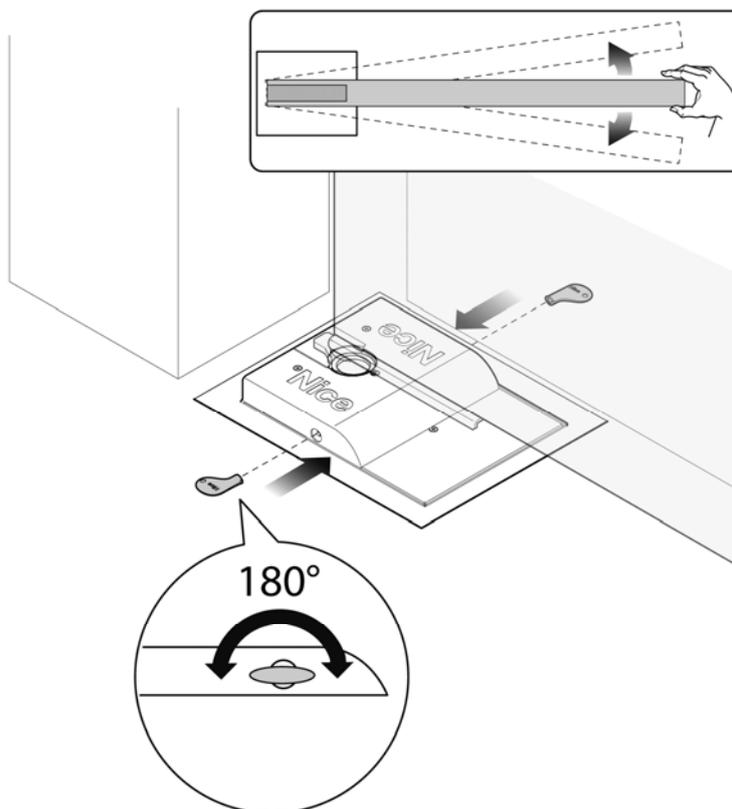
2 Déplacer manuellement le vantail et le situer dans la position souhaitée.
