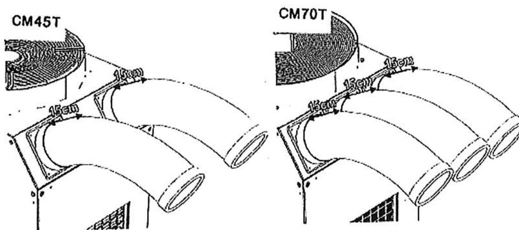
Lorsqu'un conduit (ou des conduits) est trop flexible et qu'il ne garde pas sa position d'orientation (Fig. 1), il faut le raidir en le tournant dans le sens contraire aux aiguilles d'une montre, en le prenant par la bouche d'ouverture terminale (Fig. 2).
