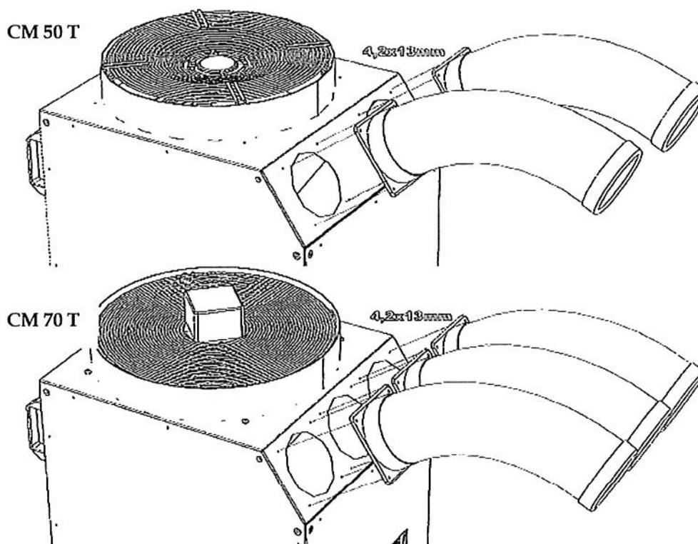
↪ **IMPORTANT** : *ne pas utiliser l'appareil sans les tuyaux flexibles d'air.*
