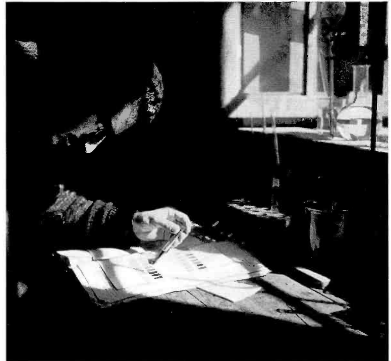
Un technicien évalue, à l'aide d'une échelle colorimétrique, la teneur en insecticide d'un échantillon prélevé par grattage d'une paroi.
