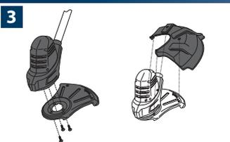
3. Montez le capot de protection sur la tête d'engrenage et fixez-le avec les vis. Fixez le capot de protection du coupe-herbe sur celui de la lame avec les vis.
