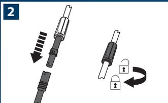
2. Alignez la partie supérieure du tube avec la partie inférieure. Les encoches en forme de triangles doivent être parfaitement alignées. Emboîtez la partie supérieure dans la partie inférieure. Fixez les deux pièces en serrant la bague de verrouillage.
