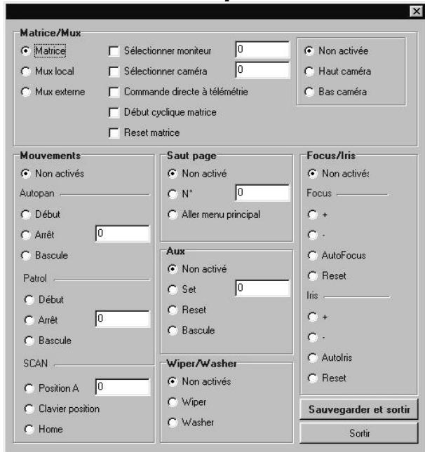
Elle permet à un poussoir d'associer des commandes à envoyer aux différents dispositifs comme par exemple des matrices, des multiplexers, des dvr, etc... La fenêtre est divisée en sections qui regroupent les différentes commandes, la première est Matrice/Mux qui permet de :
