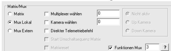
Die Schaltfläche “?” neben der Mux-Funktionsnummer ermöglicht das Öffnen des Fensters mit den zugeordneten Befehlen getrennt für jede einzelne Einrichtung. Außerdem lassen diese sich mit einem einfachen Klick der linken Maustaste anwählen. Die folgende Darstellung zeigt dieses Fenster beispielhaft.
