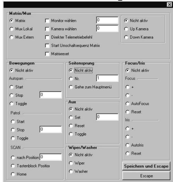
Hier lassen sich einer Schaltfläche Steuerbefehle zuordnen, die an die verschiedenen Einrichtungen geschickt werden wie etwa an Matrizen, Multiplexer, DVR etc. ... Das Fenster ist in Abschnitte unterteilt, in denen Befehle in Gruppen zusammengefaßt werden. Der erste Abschnitt Matrix/Mux gestattet folgendes:
