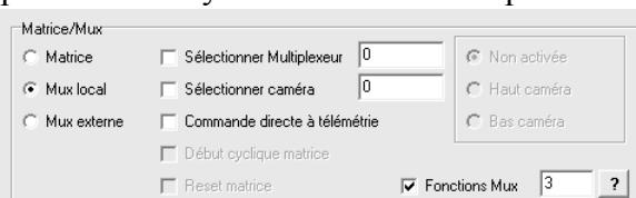
La touche "?" placée à côté du nombre de fonctions mux permet d'ouvrir la fenêtre des commandes associées à chacun des différents dispositifs et de sélectionner avec un simple click de la touche gauche de la souris. L'image suivante est un exemple de la fenêtre.
