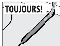
**TOUJOURS** complètement l'épissure d'usine et tout le câblage chauffant dans le mortier. Ne courbez **JAMAIS** l'épissure et ne placez **JAMAIS** aucune de ses parties dans le mur ou le sol.
