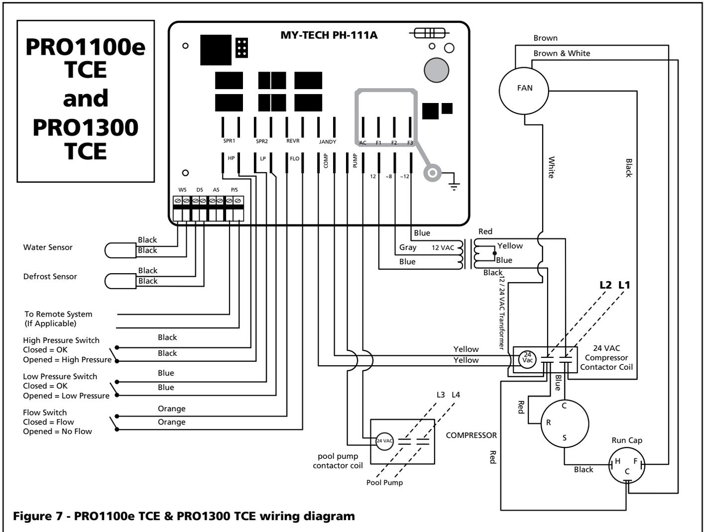
**Figure 7 - PRO1100e TCE & PRO1300 TCE wiring diagram**
