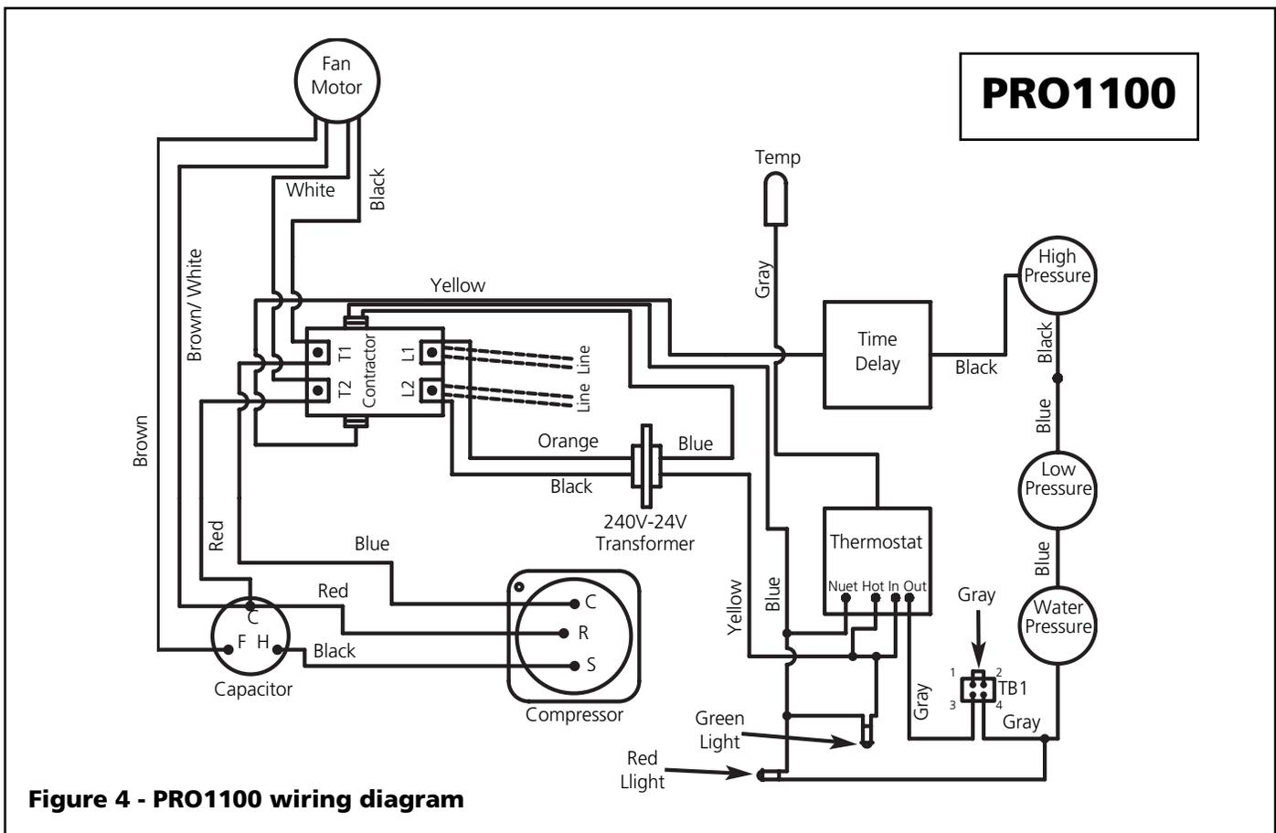
Figure 4 - PRO1100 wiring diagram
