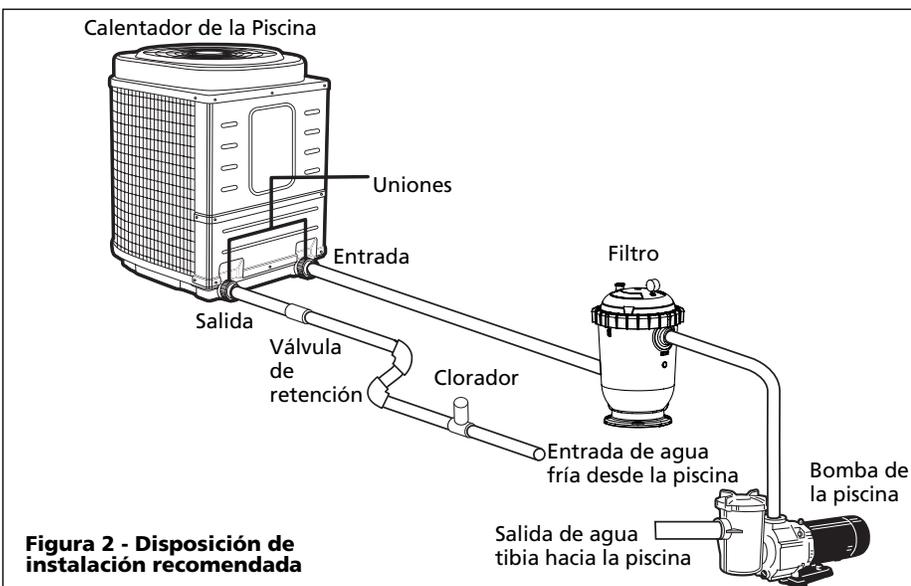
**Figura 2 - Disposición de instalación recomendada**
