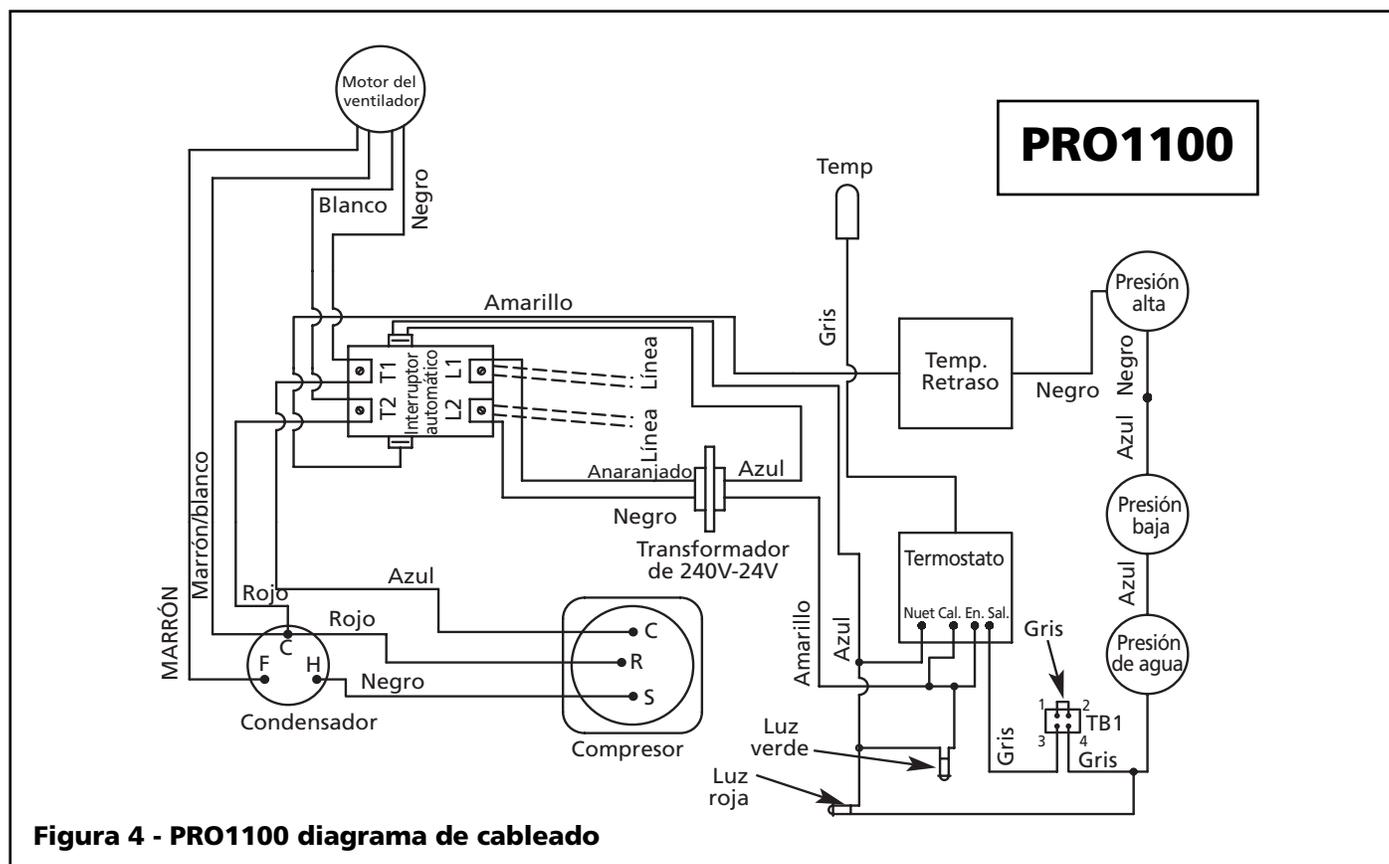
Figura 4 - PRO1100 diagrama de cableado
