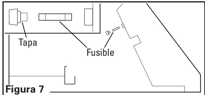
**NOTA:** Si necesita cambiar el fusible, reemplácelo únicamente con un fusible de retardo Bussman MDA-10 de 6,35 mm x 31,75 mm o con cualquier fusible cerámico de retardo de 10 amperios y 250V.
