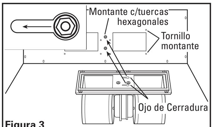
4. Usando los tornillos y las arandelas Nº 8-32 incluidos, Monte el soplador en su lugar y ajuste todos los tornillos. Confirme que el soplador esté firmemente apoyado en su lugar y que no haya brechas de aire alrededor de la junta del soplador.
