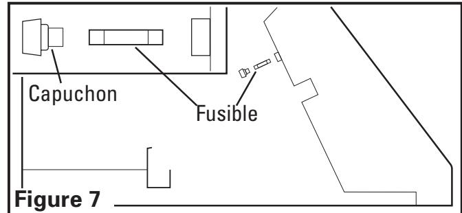
**REMARQUE :** Si vous aviez besoin de remplacer le fusible, le remplacer avec un fusible Bussman MDA-10 de 0,6 x 3,2 cm ou un fusible équivalent à 10 ampères, 250V, céramique, à retardement uniquement.
