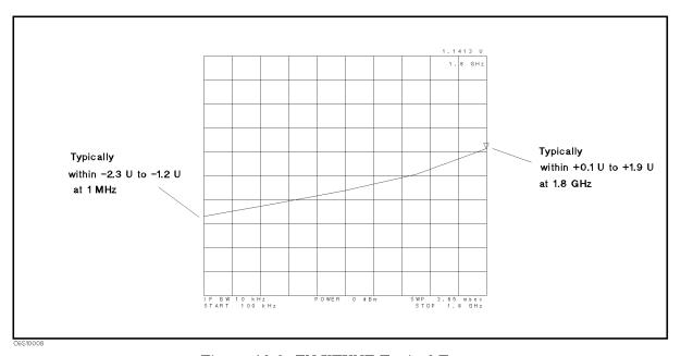
Figure 10-9. FN VTUNE Typical Trace
