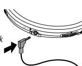
*Poznámka: Pomocí výstupu LINE OUT/ lze připojit přehrávač k systému HiFi (audio kabelem) nebo k autorádiu (adaptérkovou kazetou nebo audio kabelem). Regulátor zvuku na přehrávači je nutné v obou případech nastavit do pozice 8.*
