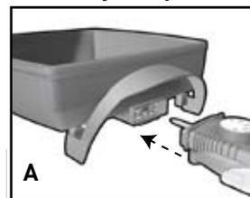
1. S'assurer que la commande de température réglable est réglée à réglage MIN. Insérer solidement la sonde dans la douille sur le côté de l'appareil (A). **S'assurer que la sonde est bien insérée.**
