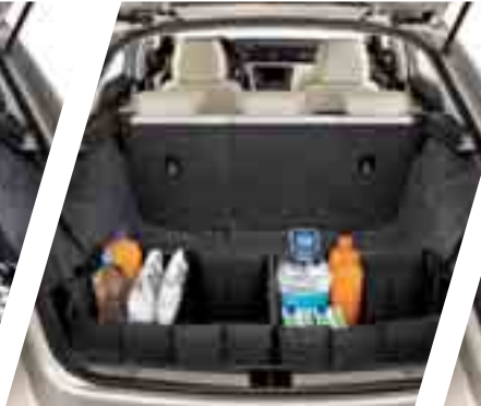
CAJAS EN CAJUELA. Kit de 2 cajas de textiles que están unidas por un velcro y tienen asas exteriores con longitud ajustable para fijar a los lados de la cajuela y para llevar fuera del vehículo en la comodidad. Va fijado al suelo de la cajuela con velcro. 1SL017221A
