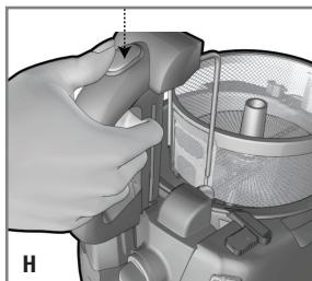
4. Coloque la cesta en la freidora y presione el botón del mango para bajarla a su posición de descanso, asegurándose que el área del mango esté centrada dentro de las ranuras del panel de control en la parte delantera de la freidora (H).
