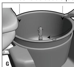
El gancho en "L" debe encajar en la muesca en el fondo de la freidora. Una vez enganchado, gire la olla a la derecha hacia el icono de cierre (LOCK) □ hasta quedar bien cerrada (Las marcas del nivel de aceite quedan directamente en el centro trasero de la freidora). Presione la lengüeta en la parte delantera derecha de la freidora, hacia la izquierda hasta quedar enganchada debajo de la olla de cocinar (G).
