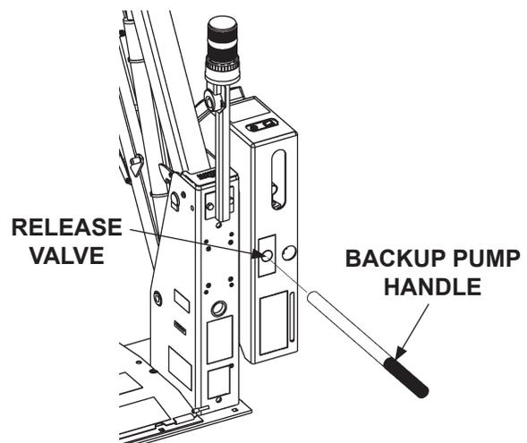
**USING BACKUP PUMP TO UNFOLD
