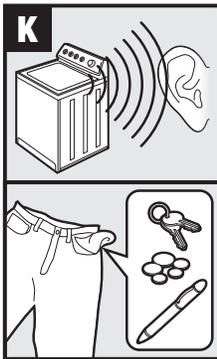
Empty pockets of all loose items to avoid the possibility of an object being lodged in the pump./Videz les poches de tout article pour éviter qu'un objet se loge dans la pompe./Vacie los bolsillos de todos los artículos para evitar la posibilidad de que un objeto quede atrapado en la bomba.
