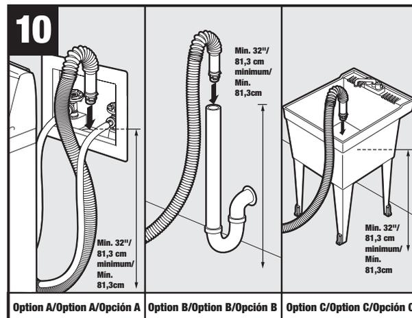
Fully insert cuff into drain pipe, approximately 3 in., or drape over sink rim./ Insérez complètement l'extrémité du tuyau d'évacuation dans le tuyau vertical, d'environ 3 po, ou placez-le sur le bord de l'évier./Instale completamente el extremo en la tubería de desagüe, aproximadamente 3 pulg., o colóquela sobre el borde del fregadero.
