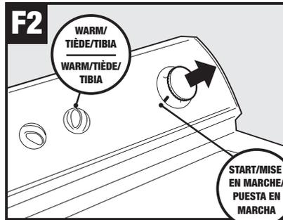
Place water temperature setting on warm/warm and pull knob to start./Réglez la température de l'eau sur tiède/tiède et tirez le bouton de mise en marche./ Coloque la temperatura del agua en tibia/tibia y tire de la perilla para ponerla en marcha.
