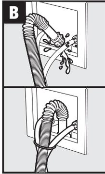
If drain hose falls out of standpipe, secure hose with tie strap as shown in step 12./Si le tuyau d'évacuation sort du tuyau vertical, fixez-le avec une attache, comme il est indiqué à l'étape 12./Si la manguera de desagüe se sale del tubo vertical, asegure la manguera con una atadura como se muestra en el paso 12.
