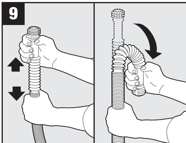
Fully extend the flexible section and form into a "C"./Étirez la section flexible et formez un « C »./Extienda completamente la sección flexible y forme una "C".
