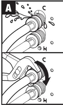
If inlet hoses leak water, tighten connection./Si les tuyaux d'arrivée d'eau fuient, resserrez les connexions./Si las mangueras de admisión escurren agua, apriete las conexiones.
