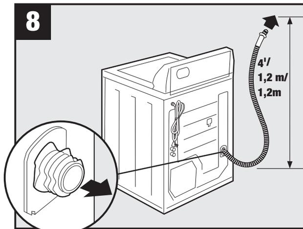
Pull out the drain hose until it stops, approximately 4 ft./Tirez sur le tuyau d'évacuation au maximum, soit environ de 4 pi./Tire de la manguera de desagüe hasta que se detenga, aproximadamente 4 pies.
