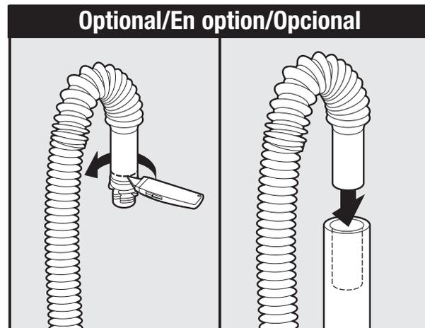
If the cuff of the hose does not fit into your stand pipe, cut off as shown./Si l'extrémité du tuyau ne pénètre pas dans le tuyau vertical, coupez-la, comme il est illustré./Si el extremo de la manguera no calza en su tubo vertical de evacuación, córtela como se muestra.
