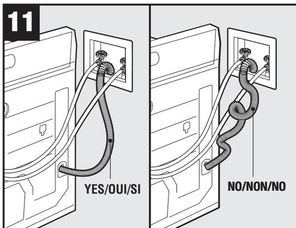
Ensure hose is not kinked./Le tuyau ne doit pas être entortillé ni plié./Asegúrese de que la manguera no esté torcida.
