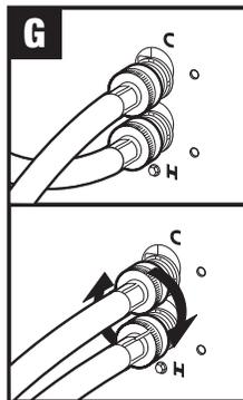
If wash water temperatures are reversed, check for proper placement of hoses./Si les températures de l'eau sont inversées, vérifiez si les tuyaux sont correctement installés./Si las temperaturas del agua de lavado están invertidas, verifique que las mangueras estén correctamente instaladas.
