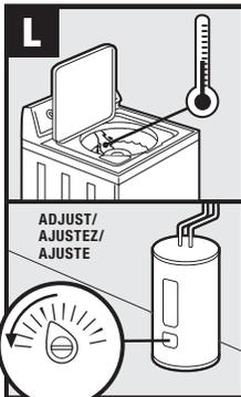
If water temperature is too hot or too cold, check setting on water heater./Si la température est trop élevée ou trop basse, vérifiez le réglage du chauffe-eau./Si la temperatura del agua es demasiado caliente o demasiado fría, verifique el ajuste en el calentador del agua.
