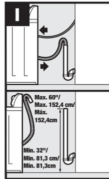
If machine is filling and draining at the same time, check for proper height of standpipe./Si la laveuse se remplit d'eau et se vide en même temps, vérifiez que le tuyau vertical est de la bonne hauteur./Si la lavadora se llena y desagua al mismo tiempo, verifique que la altura del tubo vertical sea la correcta.
