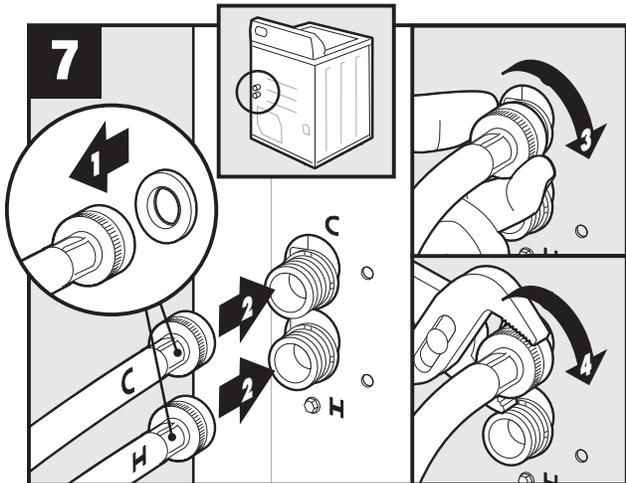
Place washers in hoses and attach to machine; take care to match up the hot and cold hoses to the correct inlet valve./Mettez les joints dans les tuyaux et fixez-les à la laveuse, en faisant correspondre les tuyaux d'eau chaude et d'eau froide aux robinets appropriés./Coloque las arandelas en las mangueras e instálelas en la lavadora, teniendo cuidado de hacer coincidir las mangueras del agua caliente y fría con las válvulas de admisión correctas.
