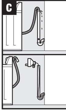
If water overflows standpipe, check pipe for obstruction and clear if possible./Si l'eau déborde du tuyau vertical, vérifiez s'il n'y a pas d'obstructions et sinon, enlevez-les./Si el agua se desborda por el tubo vertical, verifique que no hayan obstrucciones y retirelas si es posible.
