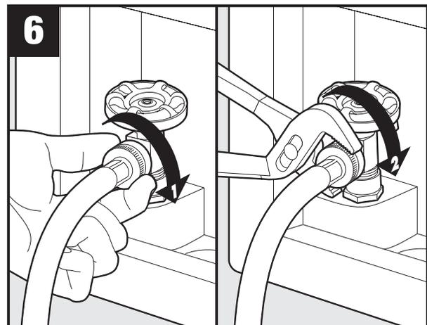
Fasten to faucets and tighten with pliers./Fixez les tuyaux aux robinets et serrez-les avec des pinces./Instale las mangueras en las llaves y apriete con pinzas.
