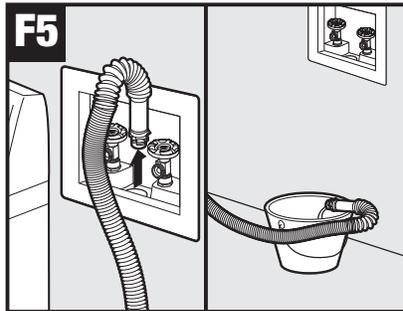
Remove drain hose and drain excess water into bucket./Enlevez le tuyau d'évacuation et faites couler l'eau restante dans un seau./ Retire la manguera de desagüe y vierta el exceso de agua en un balde.
