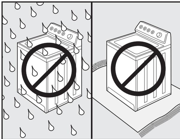
Do not place washer in the weather or on carpet./Ne placez pas la laveuse sur un tapis et ne l'exposez pas aux intempéries./No coloque la lavadora sobre una alfombra ni expuesta a las inclemencias del tiempo.
