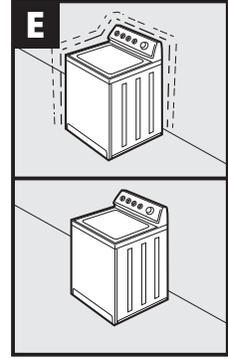
If washer is vibrating excessively, refer to step 16 in installation instructions./Si la laveuse vibre trop, reportez-vous à l'étape 16 des instructions d'installation./Si la lavadora vibra demasiado, consulte el paso 16 de las instrucciones de instalación.
