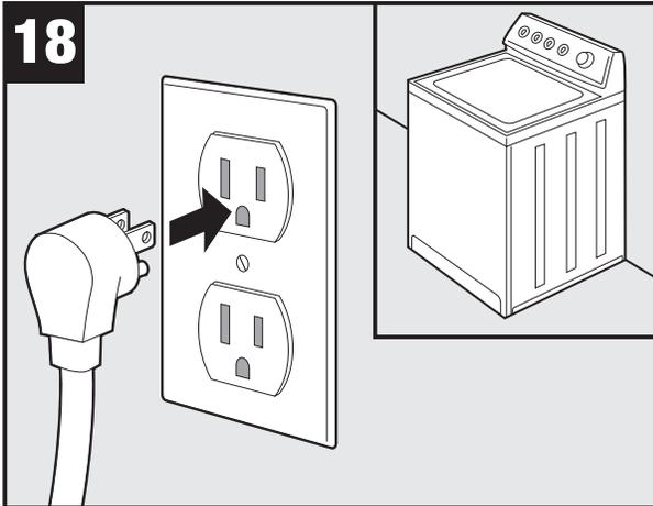
3-Pronged grounded outlet; 120V 60Hz, 15 or 20 amp rating required./Une prise 120 V, 60 Hz, 15 ou 20 A à 3 alvéoles, mise à la terre, est nécessaire./Se requiere un tomacorriente de 120 V 60 Hz, 15 o 20 Amp. de 3 alvéolos, puesto a tierra.
