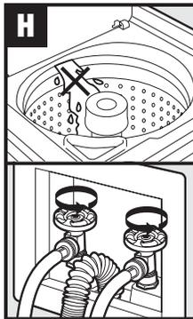
If machine does not fill with water, verify that the faucets are turned on./Si la laveuse ne se remplit pas d'eau, vérifiez que les robinets sont ouverts./Si la lavadora no se llena con agua, verifique que las llaves del agua estén abiertas.
