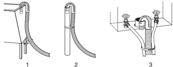
Si les robinets d'eau et le tuyau rigide de rejet à l'égout sont placés en retrait (voir l'illustration 3), introduire l'extrémité en col de cygne du tuyau de vidange dans le tuyau rigide de rejet à l'égout. Attacher fermement les tuyaux d'arrivée d'eau et le tuyau de vidange ensemble, avec la courroie perlée.
