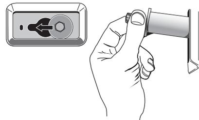
3. Lorsque les 4 boulons sont retirés, enlever le cordon d'alimentation de chaque porte-boulon et jeter les boulons, cales d'espacement en plastique et les câbles.
