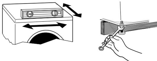
Si la laveuse est contre un mur, la déplacer légèrement avant de l'incliner vers l'arrière. Si la laveuse n'est pas d'aplomb, soulever d'abord l'avant avec un bloc de bois (2 x 4 po) et ajuster le déploiement des pieds selon le besoin, puis soulever l'arrière et ajuster le déploiement des pieds selon le besoin. Répéter ceci jusqu'à l'aplomb parfait de la laveuse.
