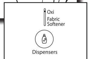
Ajouter de l'agent de blanchiment au chlore ou un activateur de linge Oxi au distributeur. Si l'on utilise des produits Oxi ou d'autres activateurs de lessive (agent de blanchiment sans danger pour les couleurs liquides ou en poudre), sélectionner l'option Oxi, appuyer sur le bouton des distributeurs jusqu'à ce qu'Oxi soit sélectionné. Il n'est pas nécessaire de sélectionner l'option Oxi lorsqu'on utilise de l'agent de blanchiment liquide au chlore.
