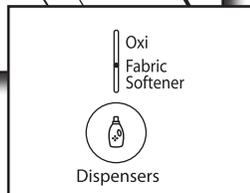
Verser une mesure d'assouplissant pour tissu liquide dans le distributeur – toujours suivre les instructions du fabricant concernant la dose d'assouplissant pour tissu à utiliser en fonction de la taille de la charge. Sélectionner ensuite l'option Fabric Softener (Assouplissant pour tissu) utilisant le bouton DISPENSERS (DISTRIBUTEURS).
