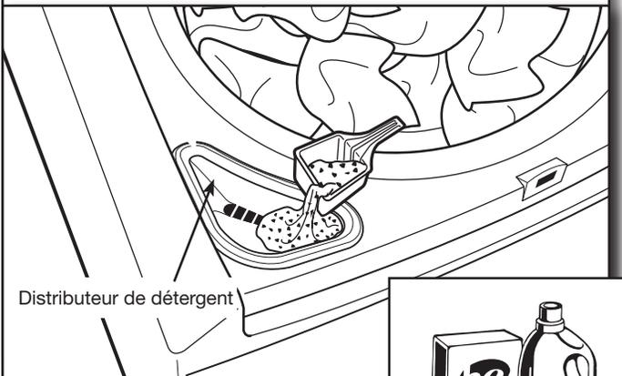
Ajouter une mesure de détergent HE dans le distributeur de détergent.
