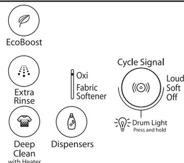
Sélectionner les autres options de programme que l'on souhaite ajouter, si ce n'est pas déjà fait. Certains programmes ajoutent automatiquement certaines options telles que Deep Clean with Heater (Nettoyage en profondeur avec dispositif de chauffage) ou Extra Rinse. Elles peuvent être désactivées si désiré.
