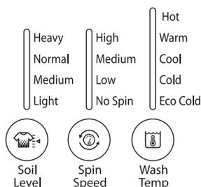
Après avoir sélectionné un programme, les réglages par défaut correspondant à ce programme s'allument. Appuyer sur les boutons de réglage du programme pour modifier le niveau de saleté, la vitesse d'essorage et la température de lavage si désiré. Tous les réglages ne sont pas disponibles avec tous les programmes.
