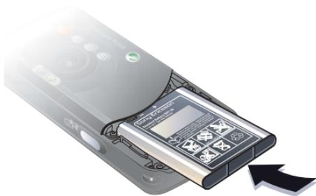
3 Insérez la batterie en orientant l'étiquette vers le haut de telle sorte que les connecteurs se trouvent en face l'un de l'autre.
