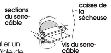
3. Installer un serre-câble de 3/4 po (agrément UL, avec marque sur le serre-câble) dans le trou au-dessous de l'ouverture du bloc de connexion. Serrer les vis du serre-câble juste assez pour que les deux parties du serre-câble soient maintenues ensemble. Faire passer le câble d'alimentation entre les deux plaquettes.
