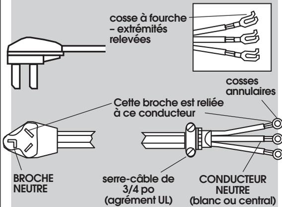
Le cordon d'alimentation à trois conducteurs doit comporter trois conducteurs de cuivre n° 10, et on doit disposer d'une prise de courant à trois alvéoles de type NEMA 10-30R.
