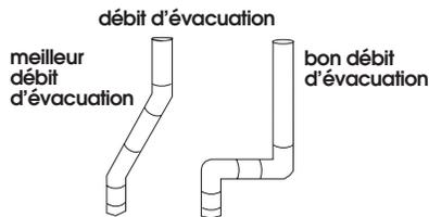
Utiliser un **conduit métallique de diamètre de 10,2 cm (4 po)**. Planifier l'installation pour introduire le nombre minimal de coudes et de changements de direction.
