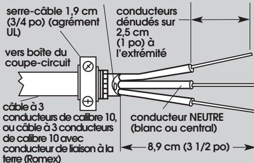
Enlever la gaine externe du câble sur 8,9 cm (3 1/2 po) à l'extrémité. Dénuder les conducteurs sur 2,5 cm (1 po). Pour un câble à 3 conducteurs plus conducteur de liaison à la terre, sectionner le conducteur de liaison à la terre à la limite de la gaine.
