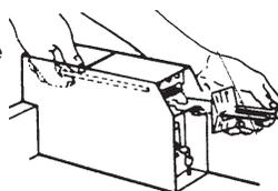
Pour une sècheuse dotée d'un mécanisme d'insertion à coulissement, utiliser l'ensemble d'adaptation fourni avec la sècheuse.
