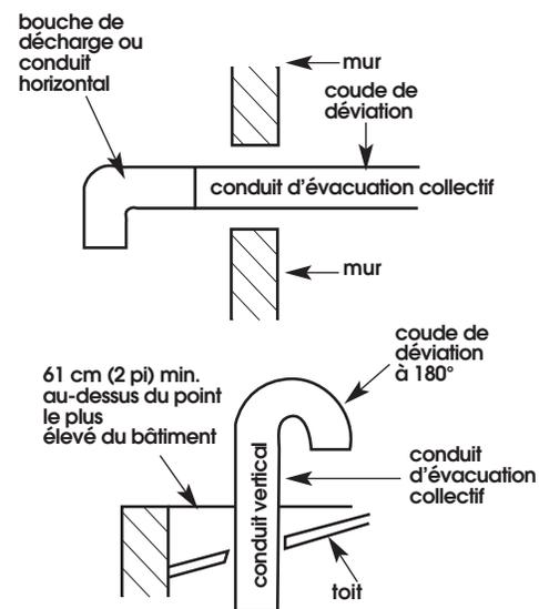
Ne pas installer une grille ou un couvercle sur l'extrémité du conduit d'évacuation.
