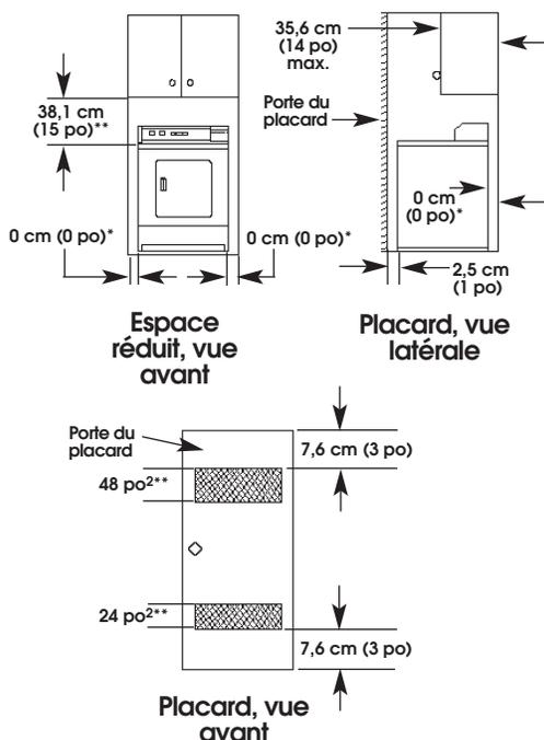
\* On doit prévoir un espacement additionnel pour tenir compte éventuellement des moulures sur mur, porte et plancher, ou si le circuit d'évacuation comporte un coude.
