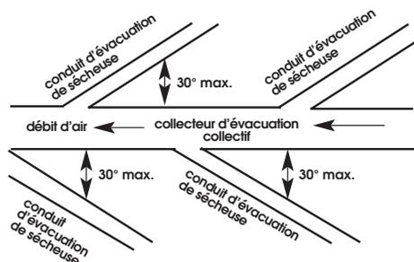
Des ensembles antirefoulement, n° de pièce 3391910, sont disponibles chez votre marchand Whirlpool et devraient être installés dans le conduit d'évacuation de chaque sècheuse pour empêcher l'air évacué de retourner dans les sècheuses et pour maintenir une pression équilibrée dans le conduit principal d'évacuation. Des orifices de passage d'air non obstrués sont requis.
