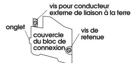
2. Ôter la vis de retenue et le couvercle du bloc de connexion.
