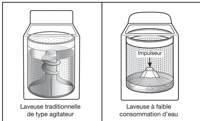
La nouveauté la plus remarquable de cette nouvelle laveuse est son système de lavage à faible consommation d'eau avec plateau de lavage. La laveuse ajuste automatiquement le niveau d'eau en fonction de la taille de la charge - nul besoin de sélecteur de niveau d'eau.
